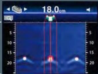
Kann ebenfalls diagonal gekrümmte Objekte in Beton wie kombinierte Kanäle oder flexible Kunststoffrohre erkennen
