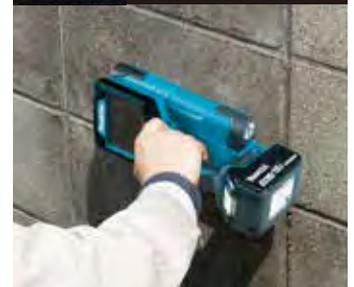
Dieses Szenario eignet sich zum Scannen von Eisenstangen in einer Backsteinwand (zusammengesetzte Objekte).
